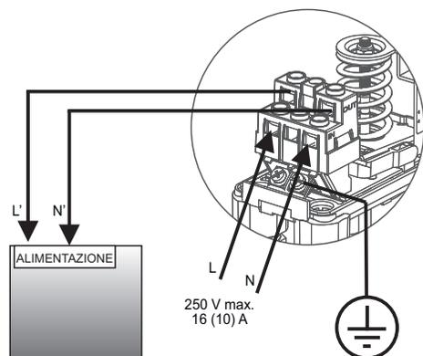
COLLEGAMENTO IN SERIE CON SICUREZZE CALDAIA:
